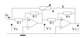
Calculer la résistance d'entrée de ce montage lorsque l'interrupteur K est fermé.
