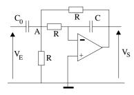
Calculer pour le régime sinusoïdal la fonction de transfert  $H(j\omega)$  de ce filtre en fonction de  $\omega$ , R, C et  $C_0$  puis de  $n=C/C_0$  et de  $x=RC\omega$ . Pour quelle pulsation, le gain est-il maximum ? Calculer  $G_{max}$
