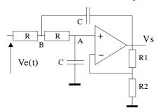
Déterminer pour le régime sinusoïdal la fonction de transfert  $H(j\omega)$  de ce filtre en fonction de  $\omega$ , R et C.
