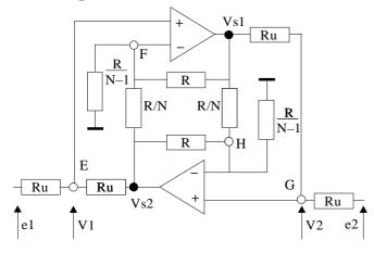
On considère le circuit ci-contre. Exprimer la conservation du courant pour les noeuds E, F, G et H en utilisant les potentiels  $V_1$ ,  $V_2$ ,  $V_{S1}$  et  $V_{S2}$ . En déduire la matrice M telle que :
