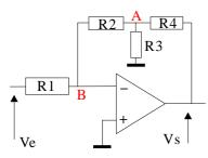
Calculer V<sub>S</sub> en fonction de V<sub>E</sub>.
