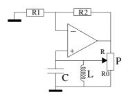
Calculer la fréquence d'oscillation du montage et la valeur minimale de la résistance  $R_0$  qui permet l'oscillation.
