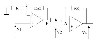
Calculer  $V_S = g(V_1, V_2)$ Quel est l'intérêt du montage ?
