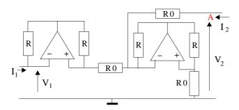
En utilisant les résultats de l'exercice 19, calculer l'impédance présentée par ce circuit lorsque l'on place une impédance  $Z_2$  en sortie ?
