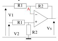
Calculer  $V_S$  en fonction des tensions  $V_1$  et  $V_2$ . Quelle est la charge vue par les générateurs  $V_1$  et  $V_2$ ?
