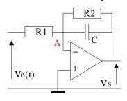
Déterminer en régime sinusoïdal la fonction de transfert  $H(j\omega)$  de ce filtre en fonction de  $\omega$ ,  $R_2$  et C.
