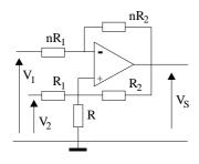
Calculer l'intensité du courant qui circule dans la résistance R.
