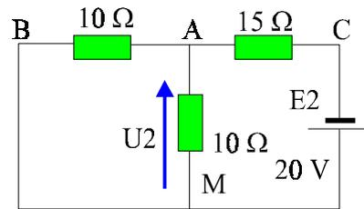
Si  $E_1 = 0$  la résistance équivalente entre A et M est  $(10 \Omega // 10 \Omega) = 5 \Omega$
