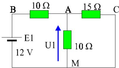
Si  $E_2 = 0$  la résistance équivalente entre A et M est  $(15 \Omega // 10 \Omega) = 6 \Omega$
